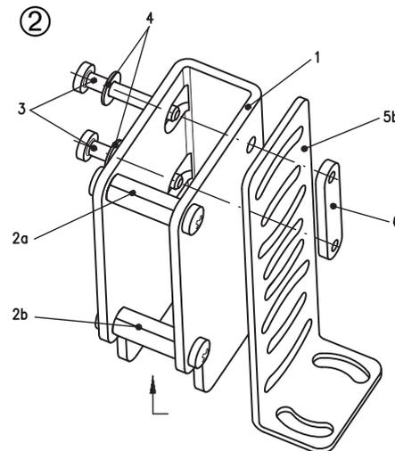
**2. Befestigungsschrauben Pos. 3 mit Unterlegscheibe Pos. 4 versehen, je nach Einbausituation gemäß Skizzen ①, ②, ③ durch das Gerät stecken und fest anziehen.**
