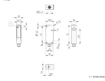
Screw M4 = 0,5 Nm Potentiometer = 40 Nmm Dimensions specified in mm (1 mm = 0,03937 Inch)
