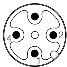
Fig. 4-1: Piedinatura del connettore a spina S4 (vista in pianta del connettore sul BIP)
