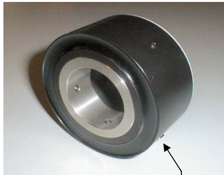
Schritt 2: Mittels der 4 Madenschrauben M4 die Remote Einheit an dem Montagering befestigen
