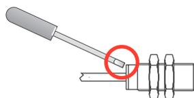
**Wichtig:** Bei jedem kapazitiven Sensor muss bei der Justage die unterschiedliche Materialbeschaffenheit des abzutastenden Produktes berücksichtigt werden.
