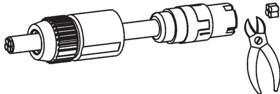
Überwurfmutter bis zum Anschlag verschrauben.
