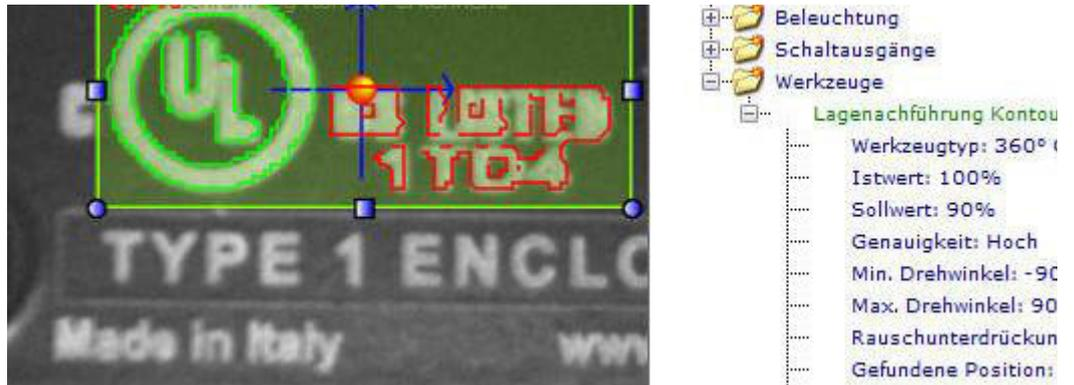
Soll die erkannte Position verwendet werden um z.B. einen Greifer zu steuern, dann sollte dieser Offset mittels einer "Referenzfahrt" während der Inbetriebnahme ausgeglichen werden.
