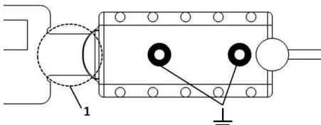
Der schmale Übergang (1) zwischen Messelektrode und Elektronikbox ist ein elektrisch und mechanisch empfindlicher Bereich. Feuchtigkeit in diesem Bereich kann den Messwert beeinflussen.
