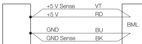
Fig. 4-4 : Bloc d'alimentation 5 V sans ligne « Sense »
