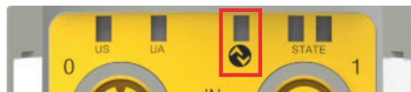
Abbildung 7: Position der LED-Anzeige IO-Link
