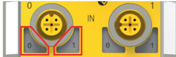
Abbildung 9: Position der LED-Anzeigen eines Eingangssports (hier am Beispiel von Port 0)
