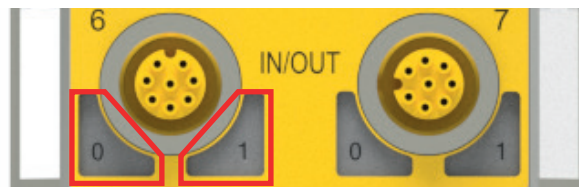
Abbildung 13: Position der LED-Anzeige eines Multifunktionsports (hier am Beispiel von Port 6)
