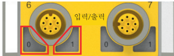
그림 13: 다기능 포트의 LED 위치(여기 표시된 포트 6)
