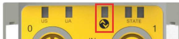
图 7: IO-Link LED 的位置
