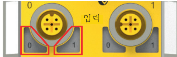
그림 9: 입력 포트의 LED 위치(여기 표시된 포트 0)
