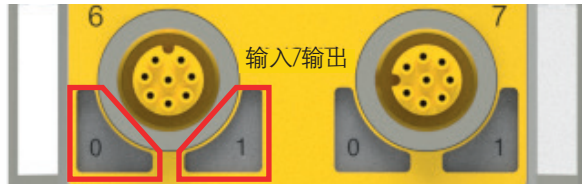
图 13: 多功能端口的 LED 位置 (图中显示端口 6)
