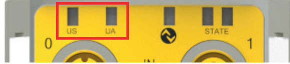
그림 5: US 및 UA용 LED 상태등 위치
