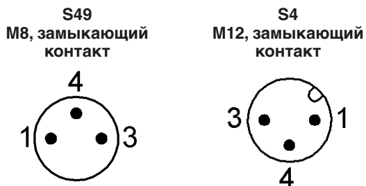
Рис. 4-5: Распределение контактов штекерного разъема (вид сверху со стороны штифтов)
