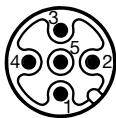
Fig. 5-6 : Affectation des broches S92 (vue de dessus sur le connecteur du BIR)
