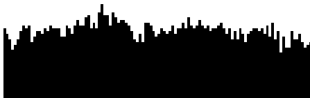
Abb. 3-7: Lichtband falsch ausgerichtet, linker Rand der CCD nicht beleuchtet
