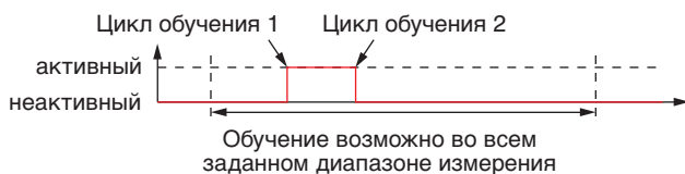
Рис. 6-2: Заданный в режиме обучения коммутационный сигнал
