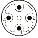
Fig. 4-4: Asignación de pines del conector S4 (vista desde arriba del conector en el BIP)
