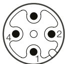
图 4-4: S4插接器的针脚分布 (从BIP插头针脚方向看)
