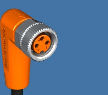
Verbinden Sie den Steckverbinder mit dem Sensor. Um die angegebene Schutzart zu gewährleisten, muss die Überwurfmutter mit einem Anzugsdrehmoment von 0,3... 0,5 Nm handfest angezogen werden. Bei Steckern ist das Anzugsdrehmoment des Gegenstücks zu beachten.
