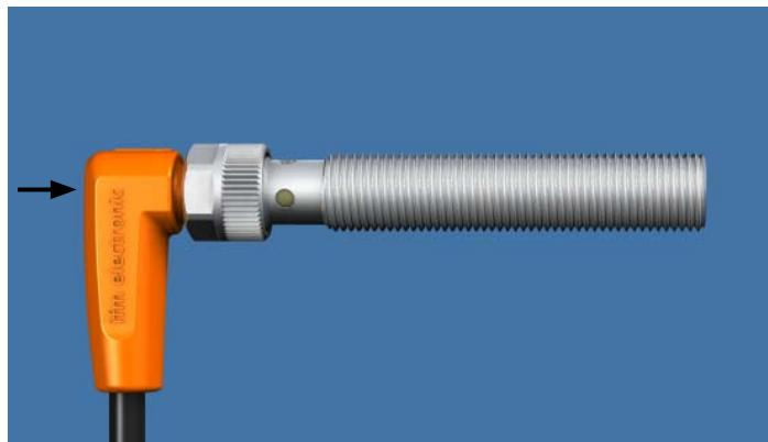
Zur Demontage lösen Sie die Überwurfmutter und drücken gleichzeitig den Steckverbinder gegen den Sensor.
