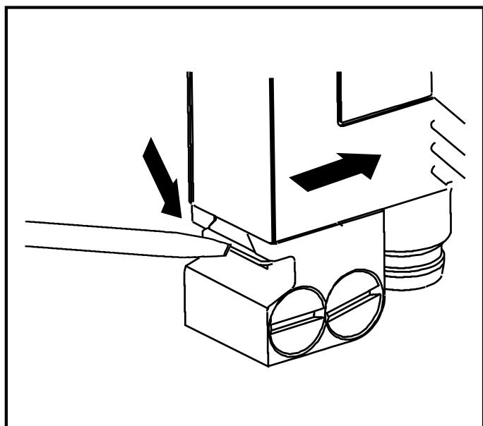
Zum Lösen des Gerätes drücken Sie die Haltefeder mit Hilfe eines Schraubendrehers nach unten und ziehen das Gerät von der Halterung.
